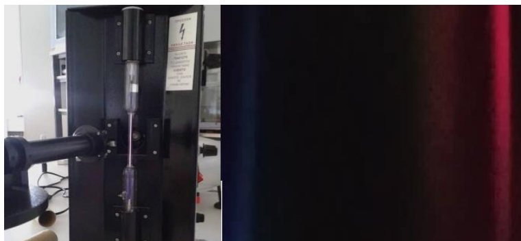
Εικόνα 1 Φως εκπνεμόμενο από μια λάμπα που περιέχει αέριο Υδρογόνο και το αντίστοιχο φάσμα του.
