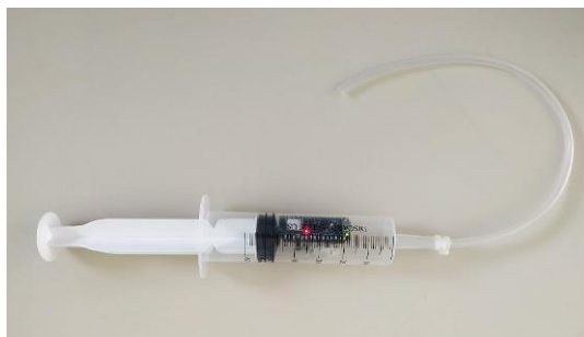
Εικόνα 3 Η σύριγγα με το Arduino και τον προσαρτημένο σωλήνα σιλκόνης
