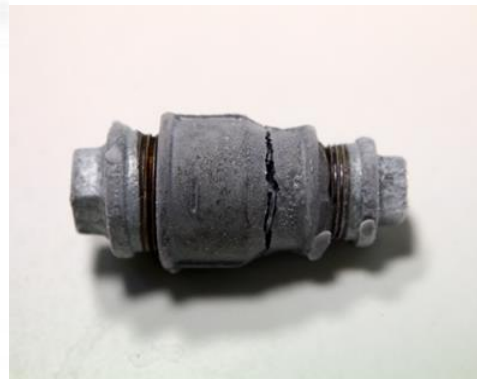
Εικόνα 2 Αναπαράσταση βόμβας διαστολής σε βιβλίο του 19ου αιώνα (αριστερά) και η προτεινόμενη διάταξη, με ορατή τη ρωγμή που ακολούθησε την πήξη του νερού
