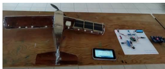
Εικόνα 4 Το αεροπλάνο, ο πίνακας προβολής των αποτελεσμάτων, το ταμπλό με το σύστημα μετρήσεων και το ασύρματο joystick
